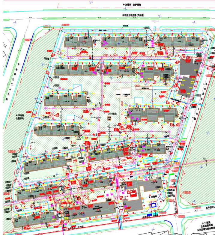
图 3.2-1-2 A-10、A-11 地块内现状管线及建筑布局图
