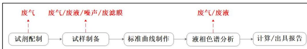
图 2-5 高效液相色谱法分析流程及产污环节示意图
