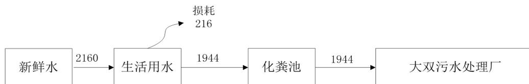
图 1-1 原有工程水平衡图 单位：m<sup>3</sup>/a
